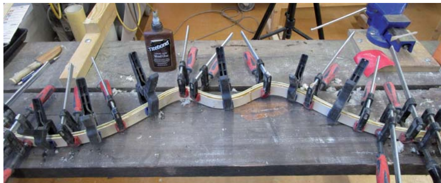
Verleimung zweier Leisten unter Verwendung einer Schablone aus Flacheisen. Für das Foto wurden die Hartgummistreifen entfernt, um die Holzleisten ins Bild zu bekommen.
