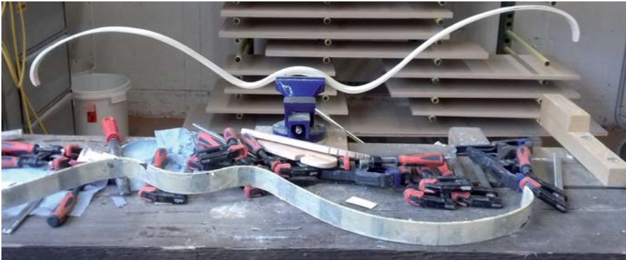
Seitenansicht nach erfolgter Verleimung
