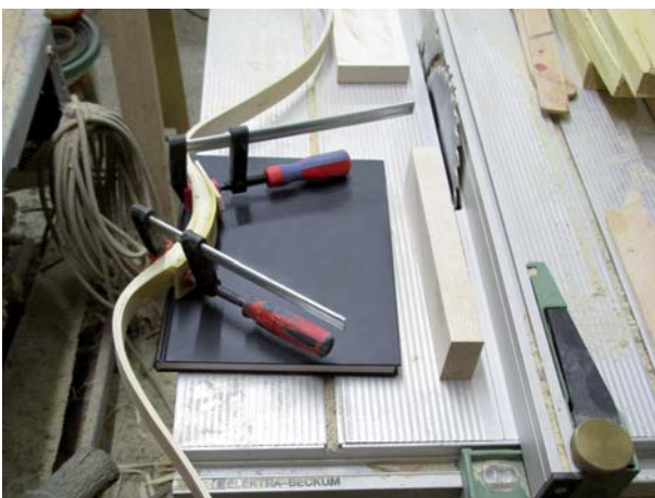
Aufleimung der nächsten Leiste (mit Druckhölzern) für den Griff
