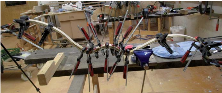
Aufleimung der ersten Leiste für den griffnahen Bereich
