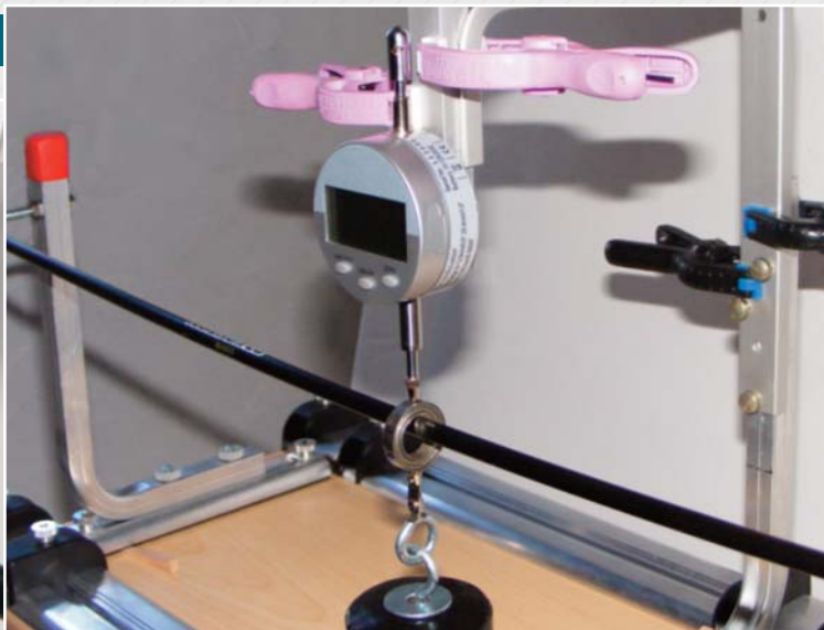
Das Gerät mit Messuhr dient auch zur Feststellung des Splines eines Schaftes.
